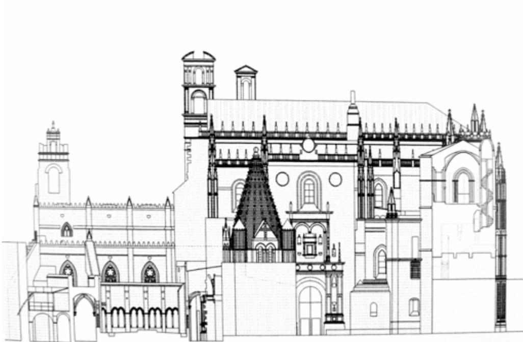
Láms. 13-14: Sección longitudinal y alzado meridional de la Catedral de Plasencia
