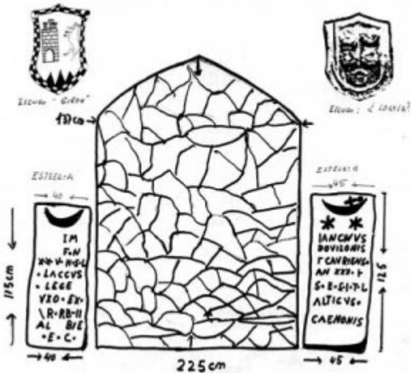
Esta es la estructura de la pared medianera encontrada al derruir la casa-cuartel de la Guardia Civil, que la separaba de la casa Durán. La pared estaba enlucida con cal y una vez retirada aparecieron los elementos del dibujo con esta composición.
